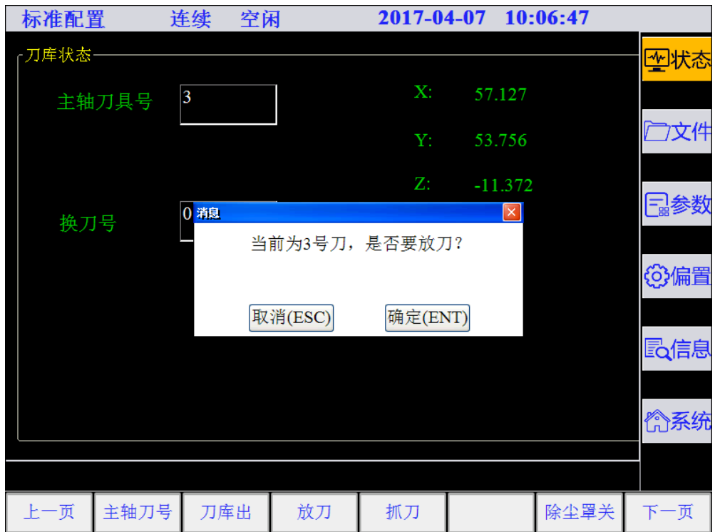
图 13-3 放刀确认对话框
