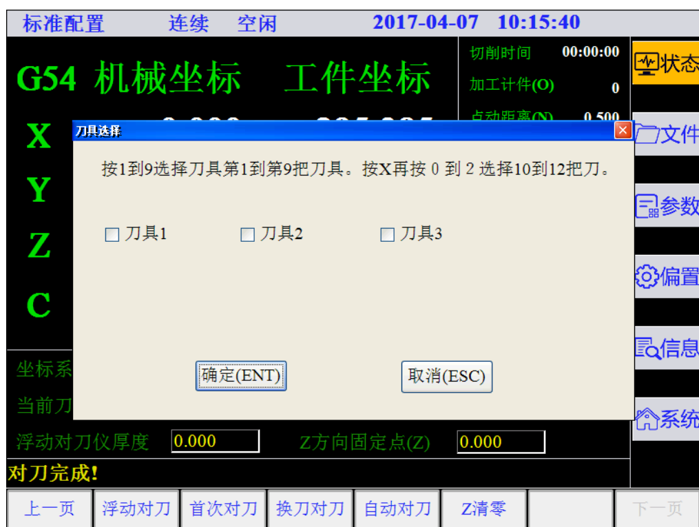
图 13-8 自动对刀选刀对话框
