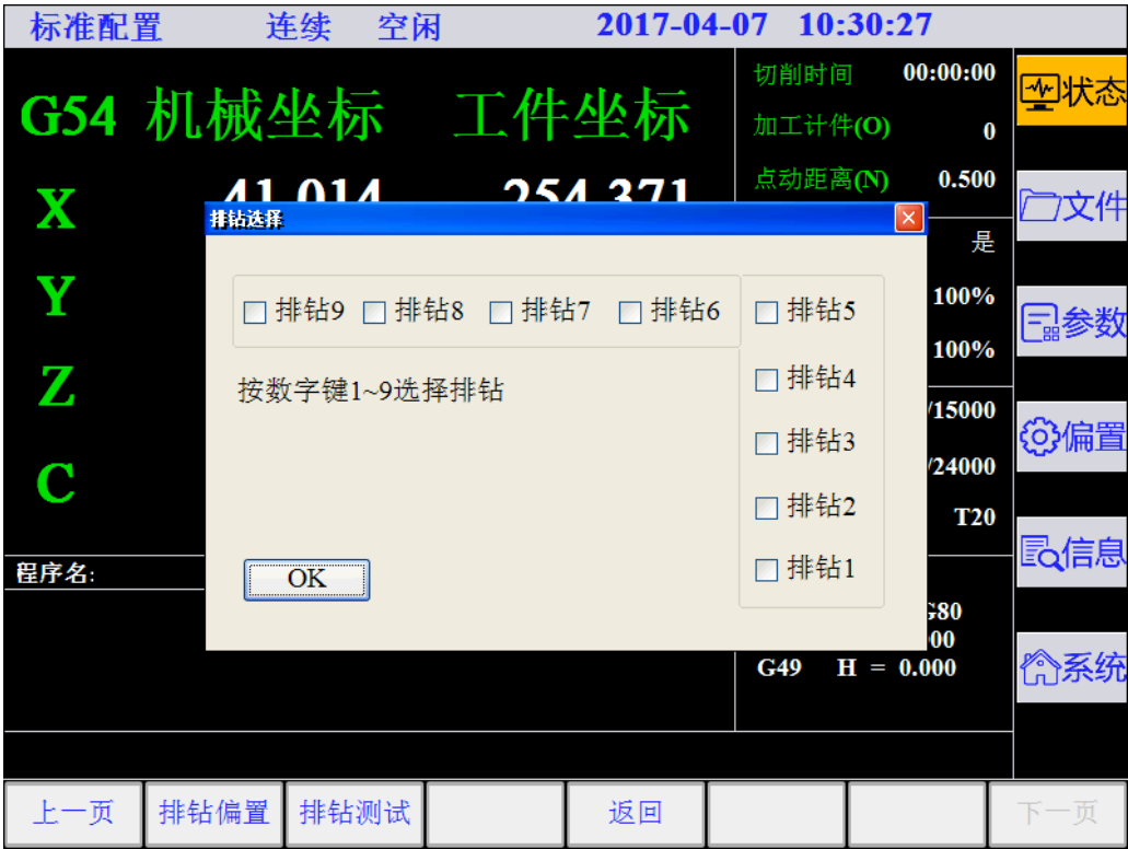
图 13-14 气缸换刀 XY 偏置设置
