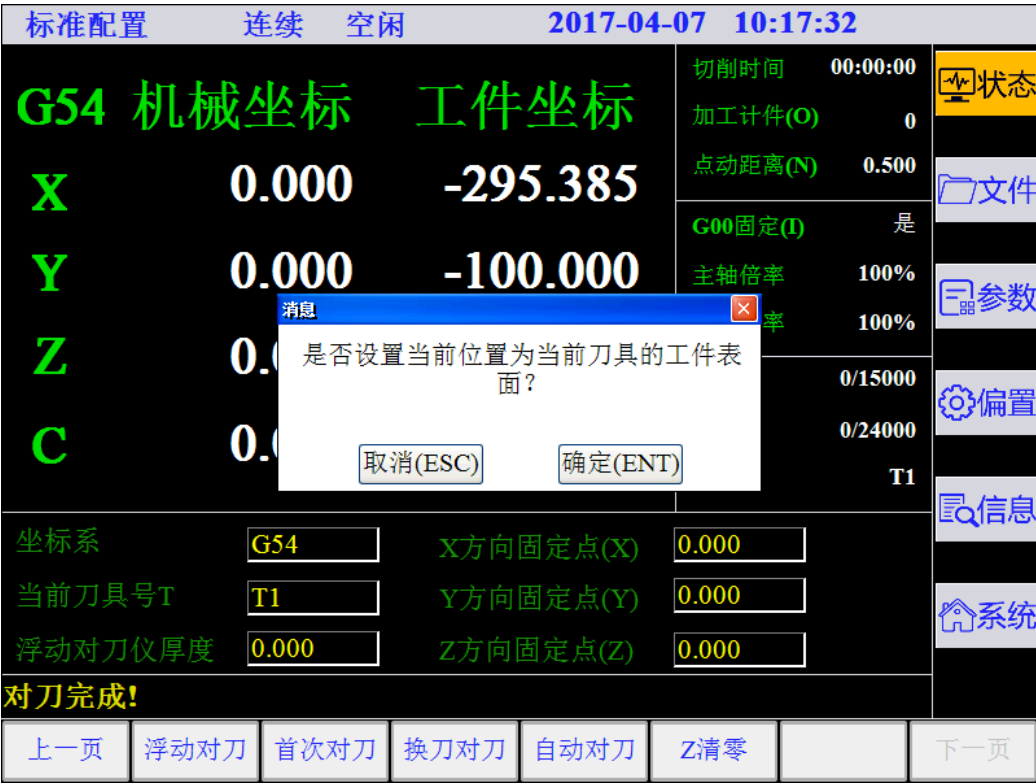
图 13-9 自动对刀选刀对话框
