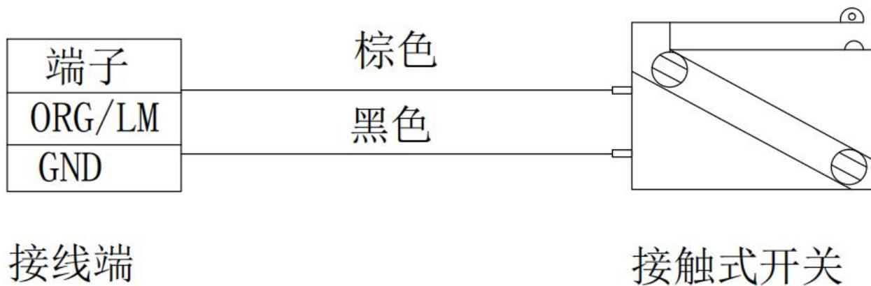
图 2-4 接触式接线图
