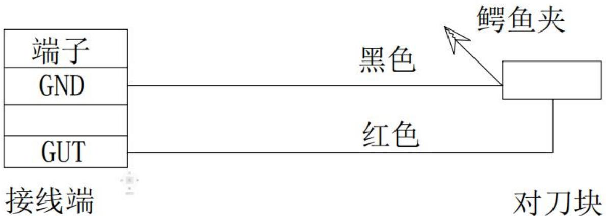
图 2-7 对刀块接线图
