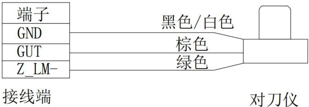
图 2-6 对刀仪接线图
