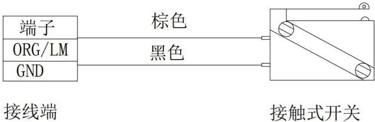
图 2-4 接触式接线图
