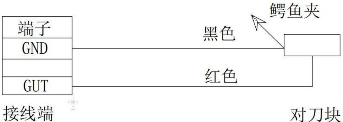
图 2-7 对刀块接线图
