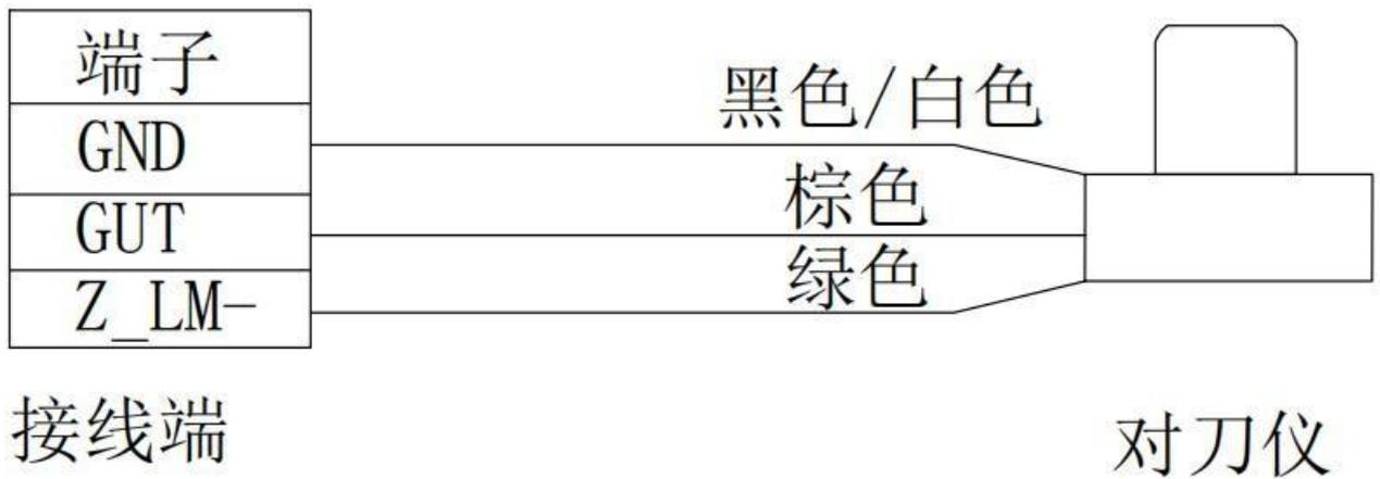
图 2-6 对刀仪接线图
